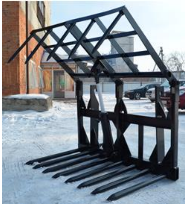
Рис. 3.5 - Універсальний сінозахоплювач (вилковий) для тракторів з фронтальним навантажувачем
