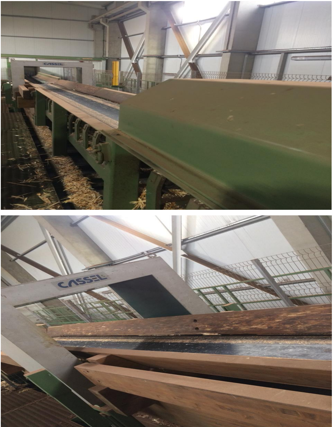
Рис. 3.7. Лінія зі сканування колод на наявність металевих предметів
