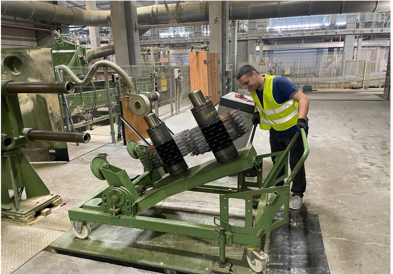
Рис. 2.7. Підготовка валів із дисковими пилами до встановлення у верстат
