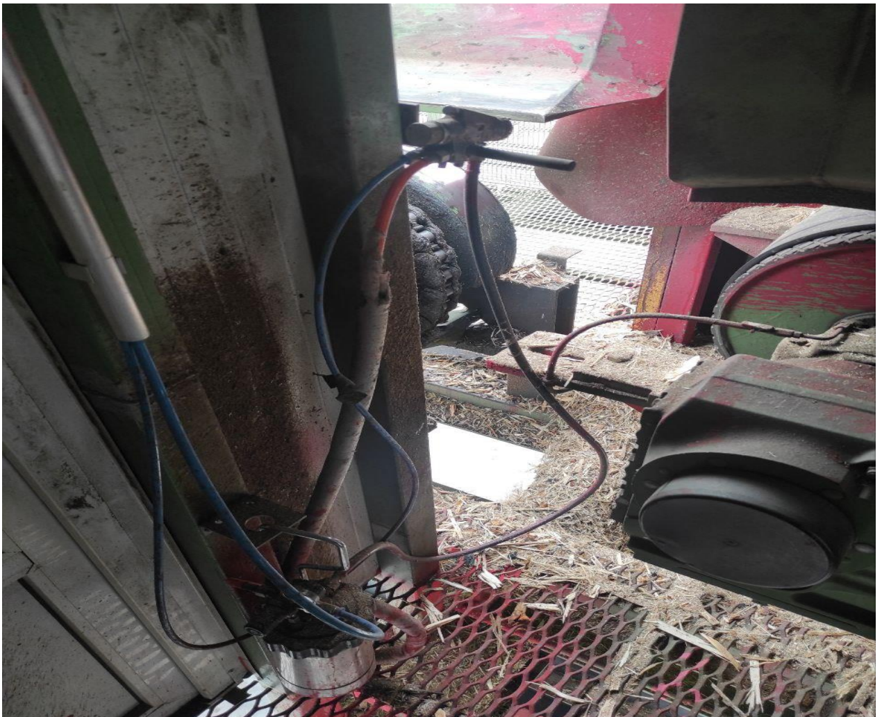
Рис. 4.4. Встановлений фарбопульт з електроклапаном
