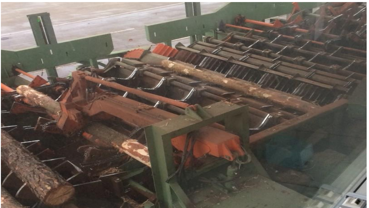
Рис. 3.4. Лінія (конвеєр) для оциліндрування колод
