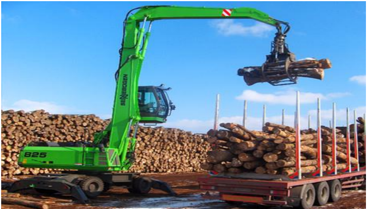
Рис. 3.2. Грейфер-екскаватор – SENNEBOGEN 825 для розвантаження та завантаження лісосировини
