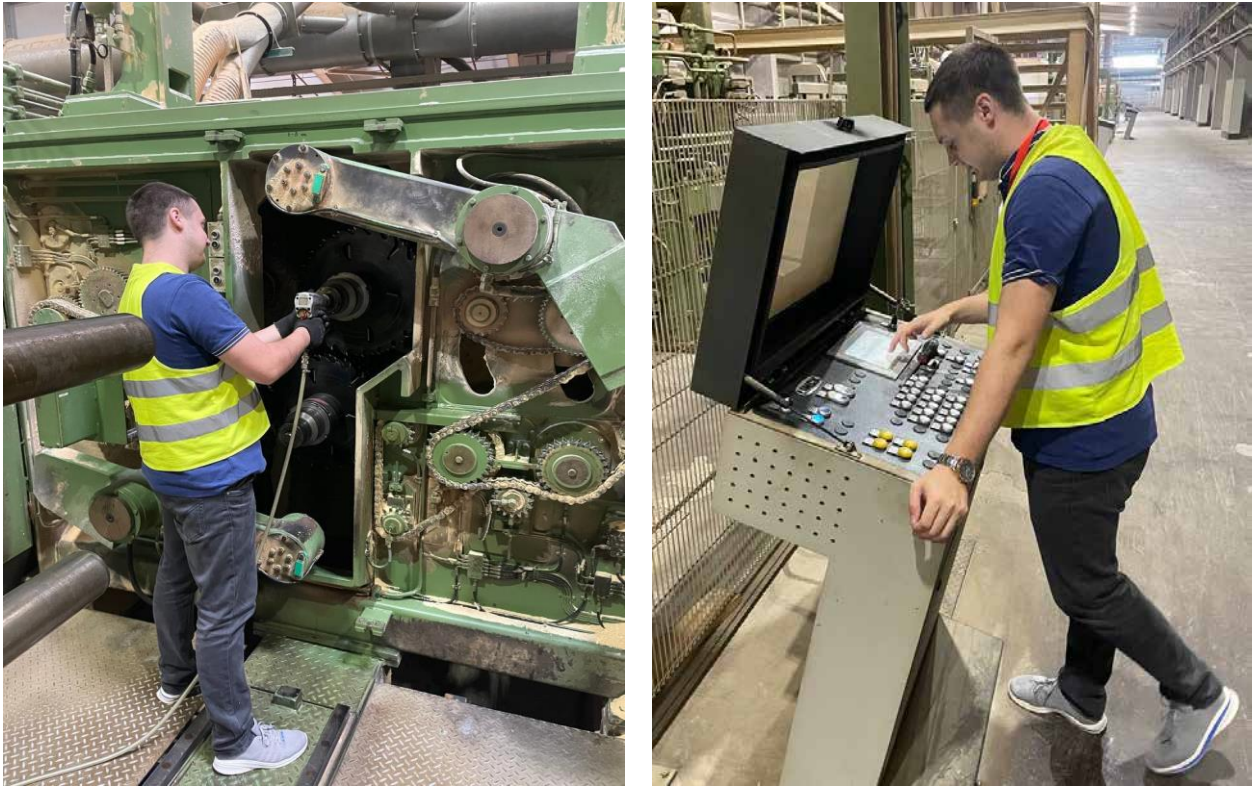
Рис. 2.4. Процес налаштування лінії з розпилювання лісоматеріалів круглих
