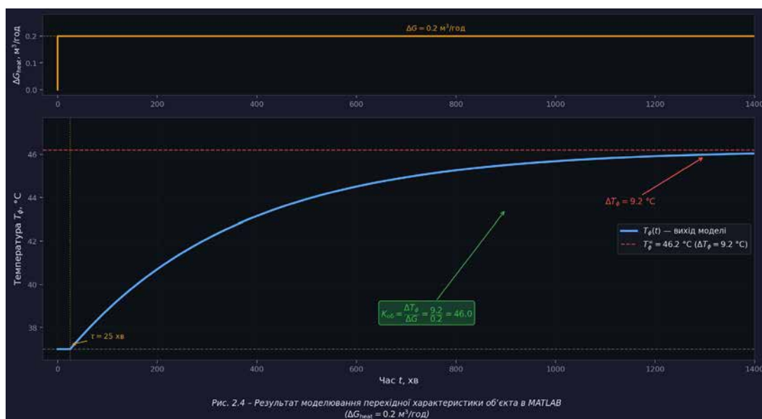
Рис. 2.4. Результат моделювання перехідної характеристики об'єкта в MATLAB ( \Delta G_{\text{heat}} = 0.2 \text{ м}^3/\text{год} )
