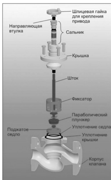
Рис. 3.7. Основні частини регулюючого клапана
