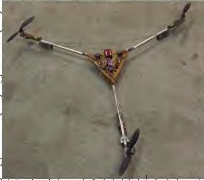
Рис. 1.3. Трікоптер. Один з перших мультикоптерів
