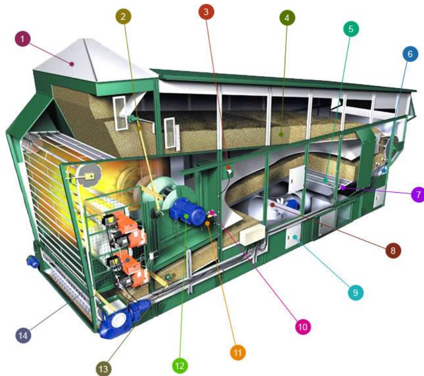
Рис. 1.2. Технологічна схема конвеєрної зерносушарки Alvan Blanch 1 – герметичний бункер; 2 – регулятор глибини потоку; 3 – термостатичний контроль температури; 4 – контроль продукту; 5 – жалюзійні ліжка; 6 – автоматичний контроль вологості і температури зерна; 7 – тяговий ланцюг; 8 – холодний вентилятор з глушником; 9 – дверцята доступу; 10 – регулювання об’єму повітря; 11 – індикатор тиску в камері; 12 – вентилятор гарячого повітря; 13 – пробник зерна; 14 – автоматичні дизельні, газові пальники або твердопаливні.
