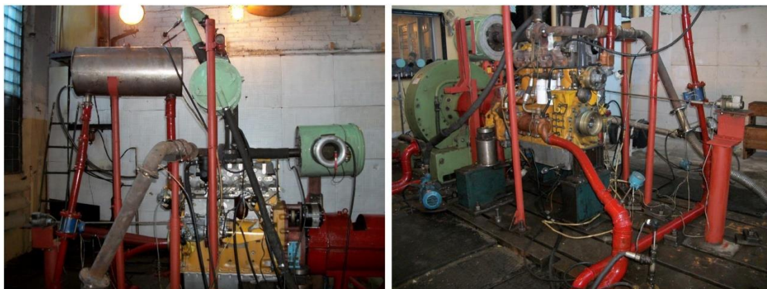
Рисунок 3.3 – Встановлення дизеля 4ЧН13/15 на стенді
