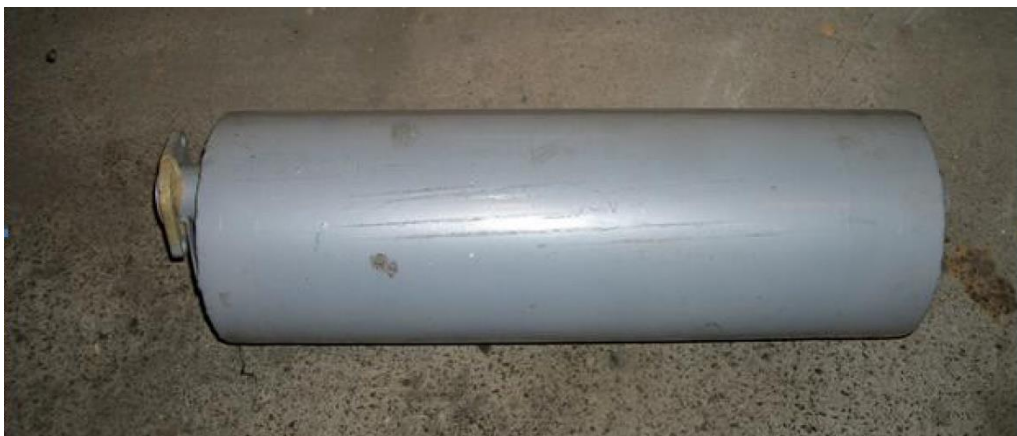
Рисунок 3.4 – Нейтралізатор відпрацьованих газів
