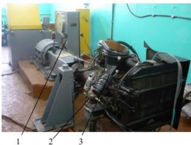
Рисунок 4.18 - Загальний вигляд експериментальної моторний установки: 1 - стенд гальмівний KI-5543; 2 - система відведення відпрацьованих газів; 3 – двигун EA113
