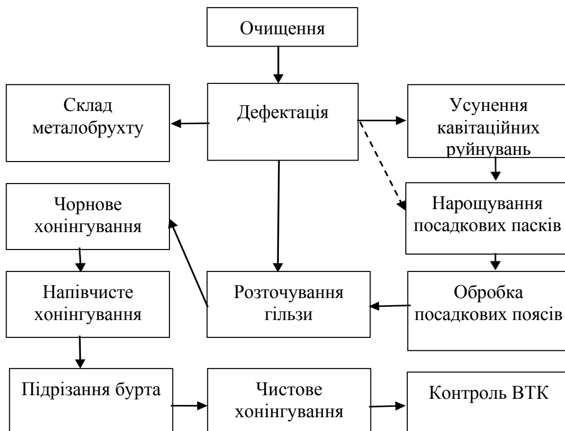
Рисунок 1.5 - Схема маршрутів технологічного процесу відновлення гільз циліндрів методом ремонтних розмірів
