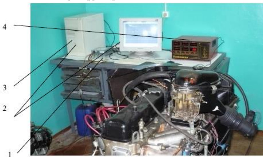
Рисунок 4.20 - Вимірювально-реєструючий комплекс: 1 - блок харчування; 2 - системний блок з монітором; 3 – АЦП; 4 – газоаналізатор Інфракар М1-0
