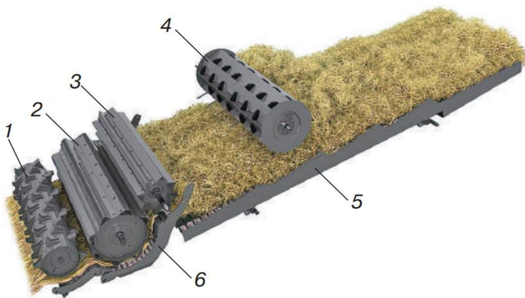
Рис. 2.20. Елементи схеми обмолочування та сепарації комбайна Claas Lexion: 1 - прискорювальний барабан системи APS; 2 - молотильний барабан; 3 - відбійний бітер; 4 - бітер з активними пальцями (барабан MSS); 5 - клавіші соломотряса; 6 - підбарабання
