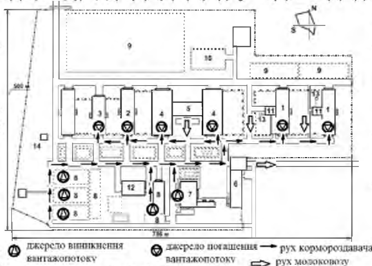
Рисунок 3.6 – План-схема генерального плану тваринницької ферми господарства та схема організації вантажопотоків.
