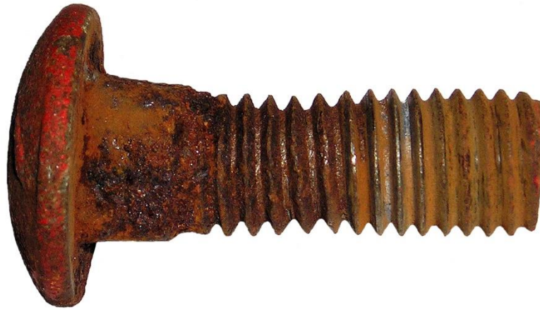
Рис. 2.1. Болт М12, що утримує боковину секції молотильного апарата, деформований унаслідок надмірного осьового натягу (на всіх рисунках масштаби можуть відрізнятися).
