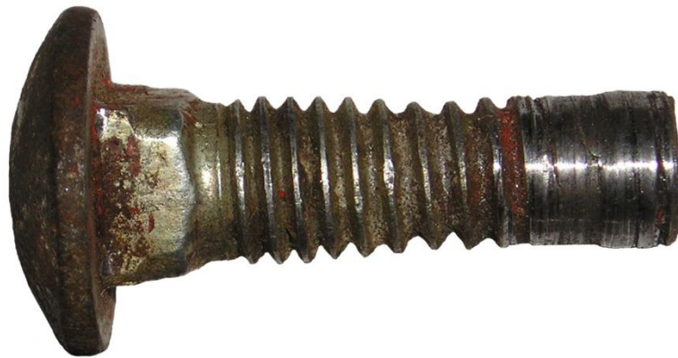
Рис. 2.3. Болт М10 контрприводу, деформований через надмірне осьове зусилля під час монтажу, а також різьба, яка постраждала внаслідок зминання.
