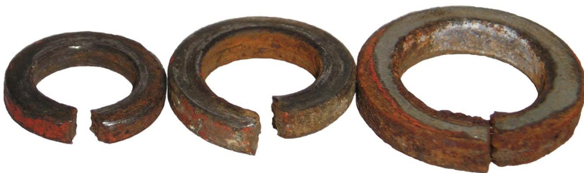
Рис. 2.8. Пружинні шайби діаметром 8, 10 та 12 мм із залишковою деформацією.
