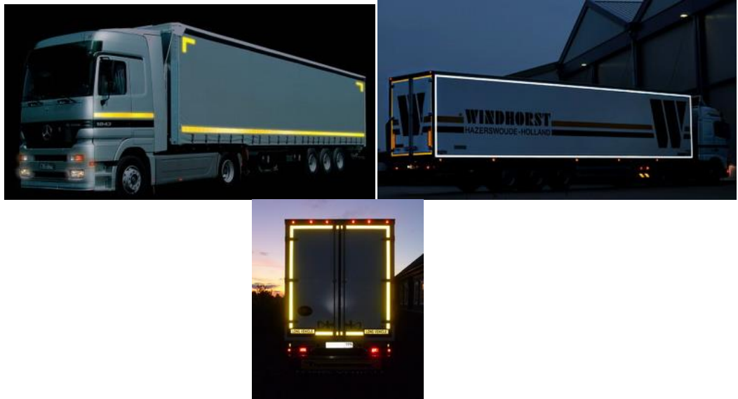
Рис. 4.1. Підвищення безпеки шляхои використання світловідбиваючої стрічки
