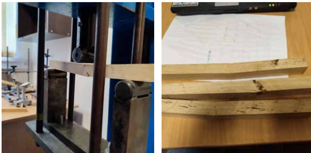
Рис. 4.7. Вигляд руйнування пиломатеріалу Дубу
