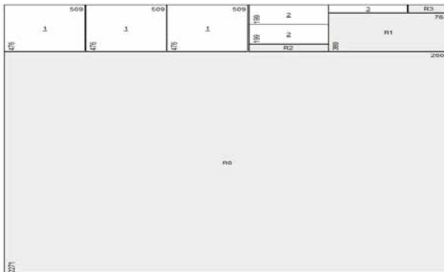
Рис 5.2. Карта розкрою ДСП Білий еліт 16 мм
