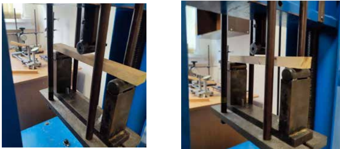
Рис. 4.3. Встановлення зразків у розривну машину Р-5
