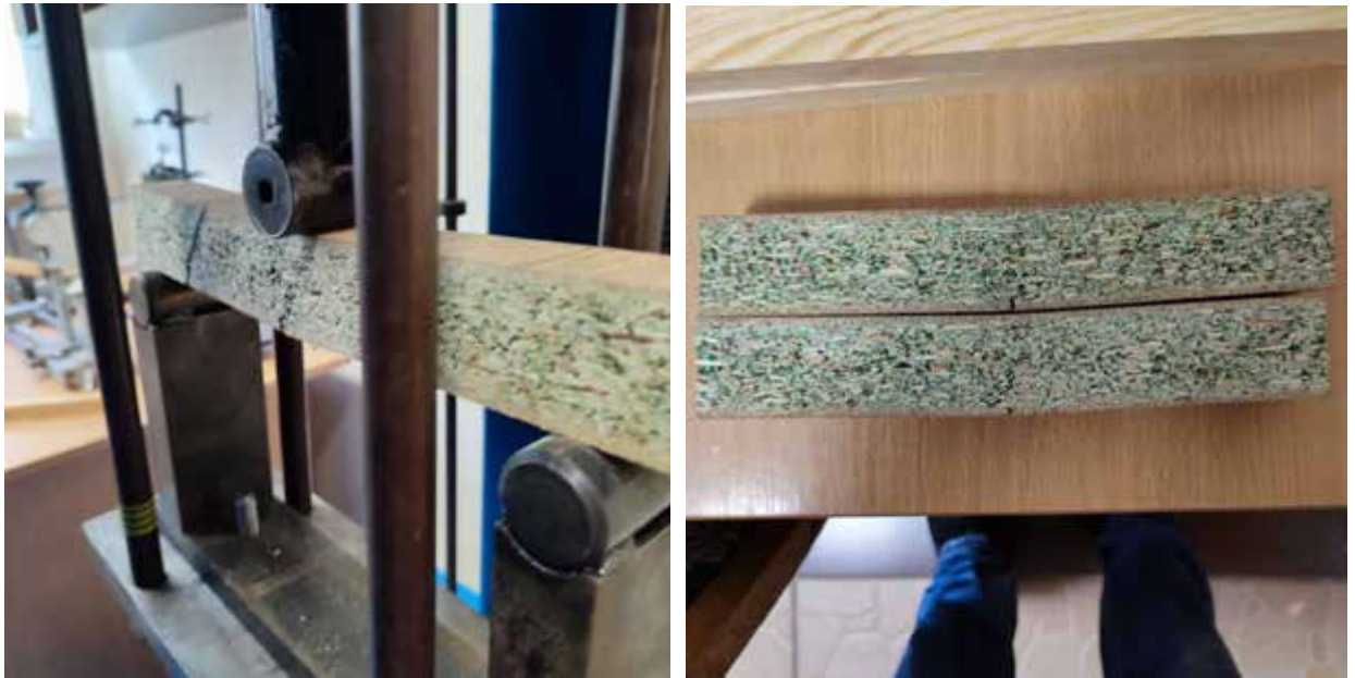
Рис. 4.4. Вигляд руйнування ДСП після проведеного дослідження
