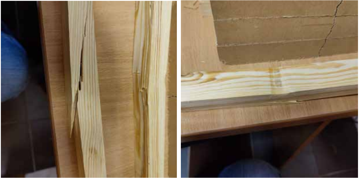
Рис 4.5 Вигляд руйнування пиломатеріалу сосни
