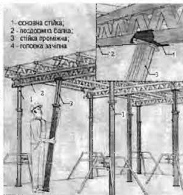
мал.16. Монтаж проміжних стійок
