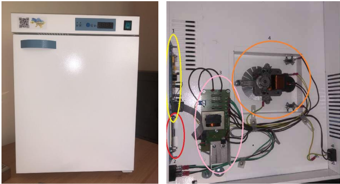
Рис. 3.3. Об'єкт управління – термостат ТС-200 та його вузли
