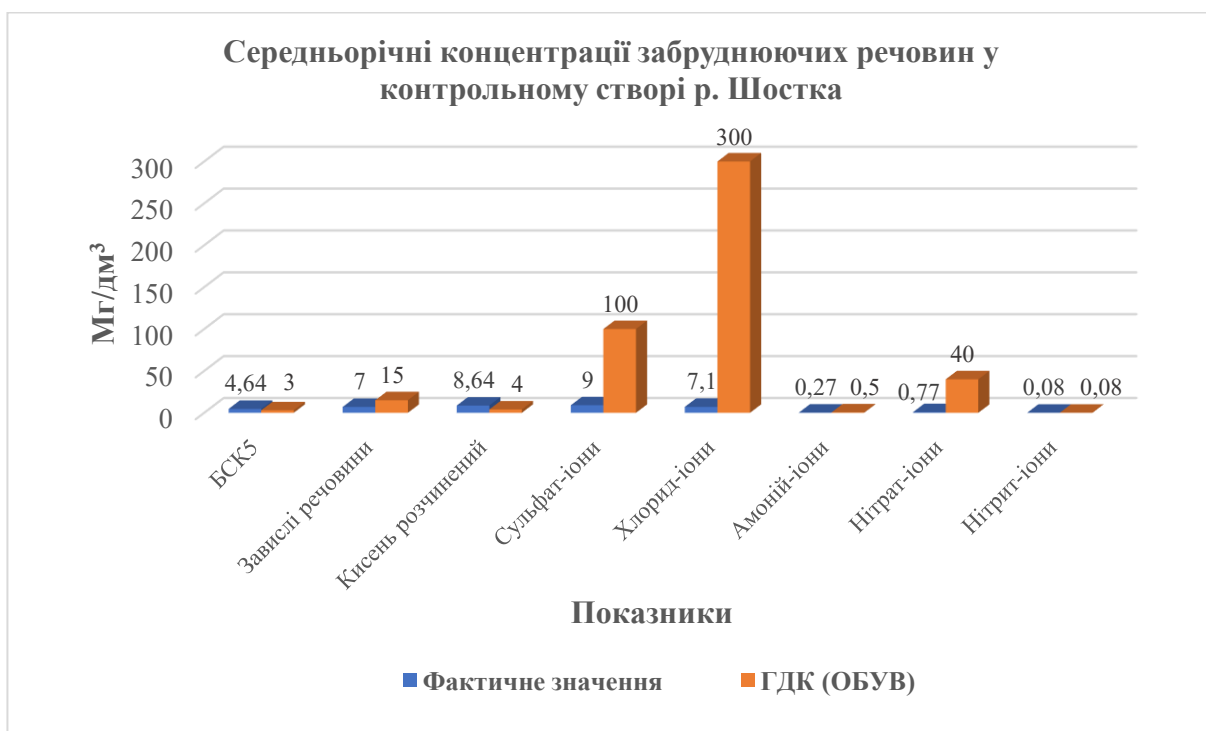
Рис. 3.2. Порівняння середньорічних концентрацій досліджуваних показників в контрольному створі р. Шостка з ГДК (ОБУВ) для водойм рибогосподарського використання, мг/дм 3
