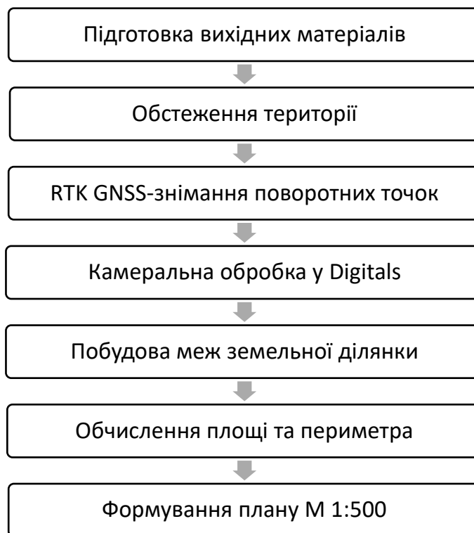
Схема 3.1. Послідовність геодезичних робіт
