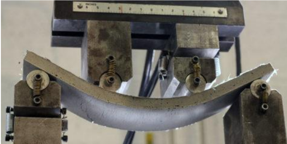
Рис. 4. Випробування зразка плитної конструкції із наномодифікованого бетону
