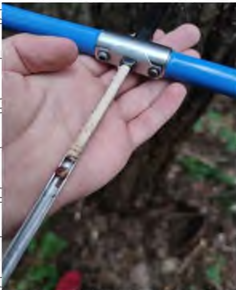
Рис. 2.1. Відбір кернів за допомогою вікового буру Haglöf
