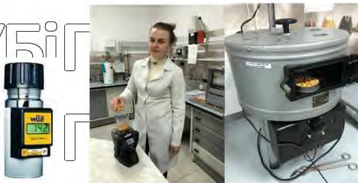
Рисунок 2.3. Вимірювання вологості зерна за допомогою вологомірів та сушильної шафа
