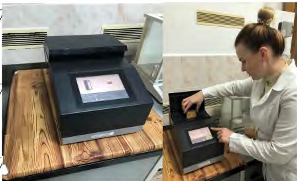
Рисунок 2.5. Визначення крохмалю, білка, олії та вологи методом інфрачервоної спектроскопії на приладі Kett AN-920
