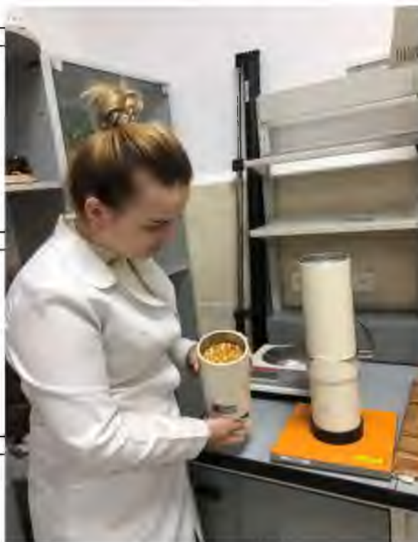
Рисунок 2.4. Визначення натури зерна на літровій пурці
