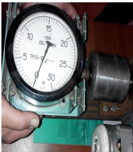
Рис. 2.3. Вимірювання фактичної частоти обертання кулькового млина.
