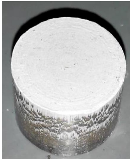
Рис. 2.9. Таблетка отримана пресуванням в штампі
