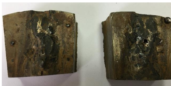
Рис. 2.11. Зразки чавуну з наплавленими валиками
