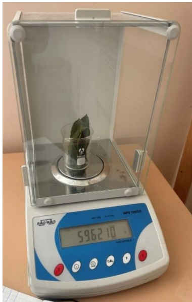
Рисунок 3. Зважування після висушування
