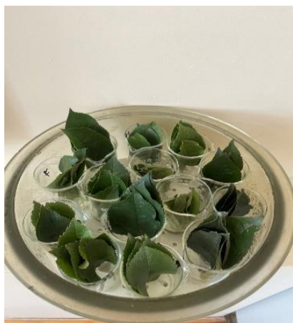
Рисунок 2. Зразки поміщено у кристалізатор для насичення
