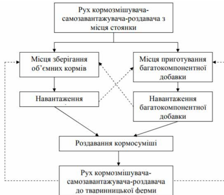
Рис.3.1. Принципова схема доставки та роздавання кормів кормозмішувачем-роздавачем, що обладнаний системою самозавантаження та зважування.
