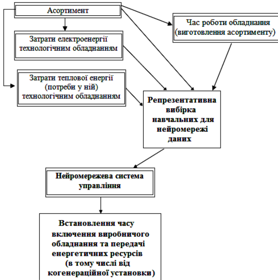
Рис. 6. Принципи використання електротехнологічної системи керування з метою підвищення енергоефективності випікання хлібобулочних продуктів
