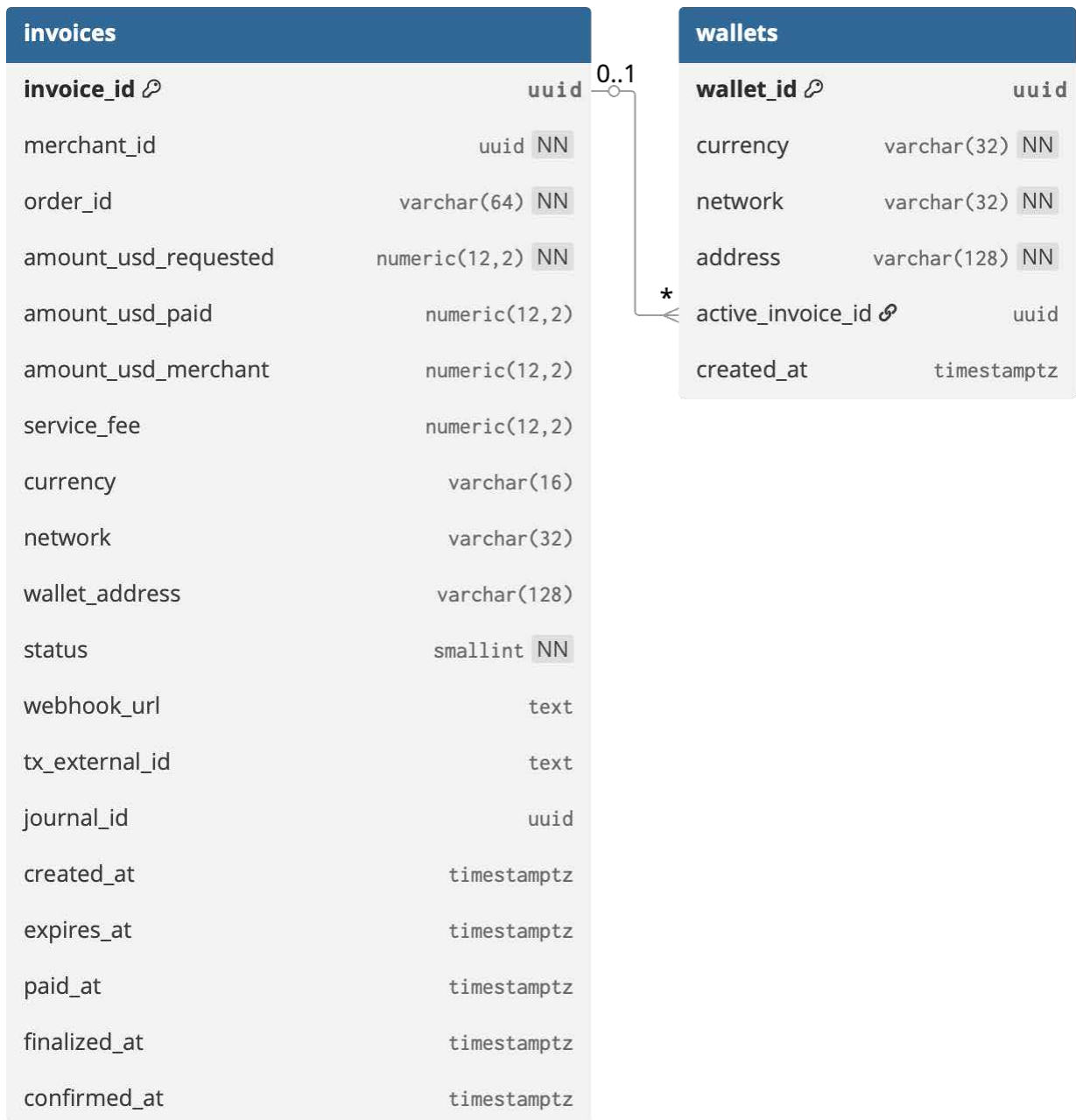
Рисунок 3.8 - Структура бази processor
