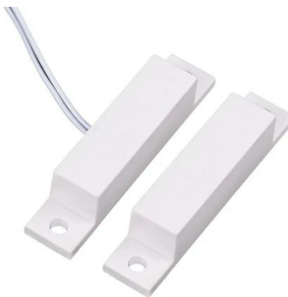
Рис. 2.6 – Датчик дверей типу reed для зворотного контролю стану проходу
