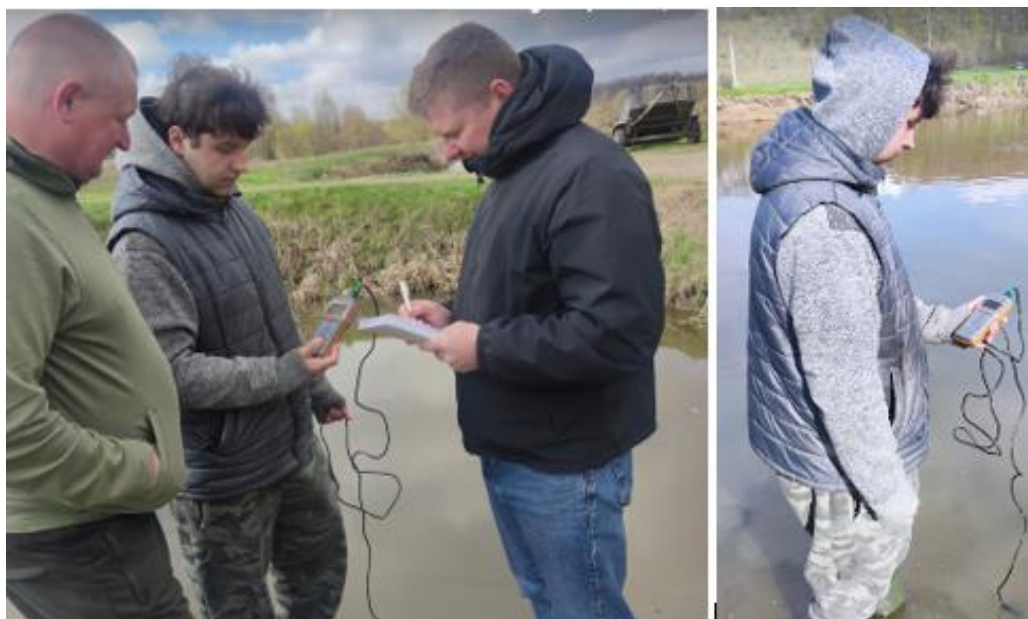
Рис. 2.4. Визначення рН, кількості розчиненого у воді кисню та ТДС
