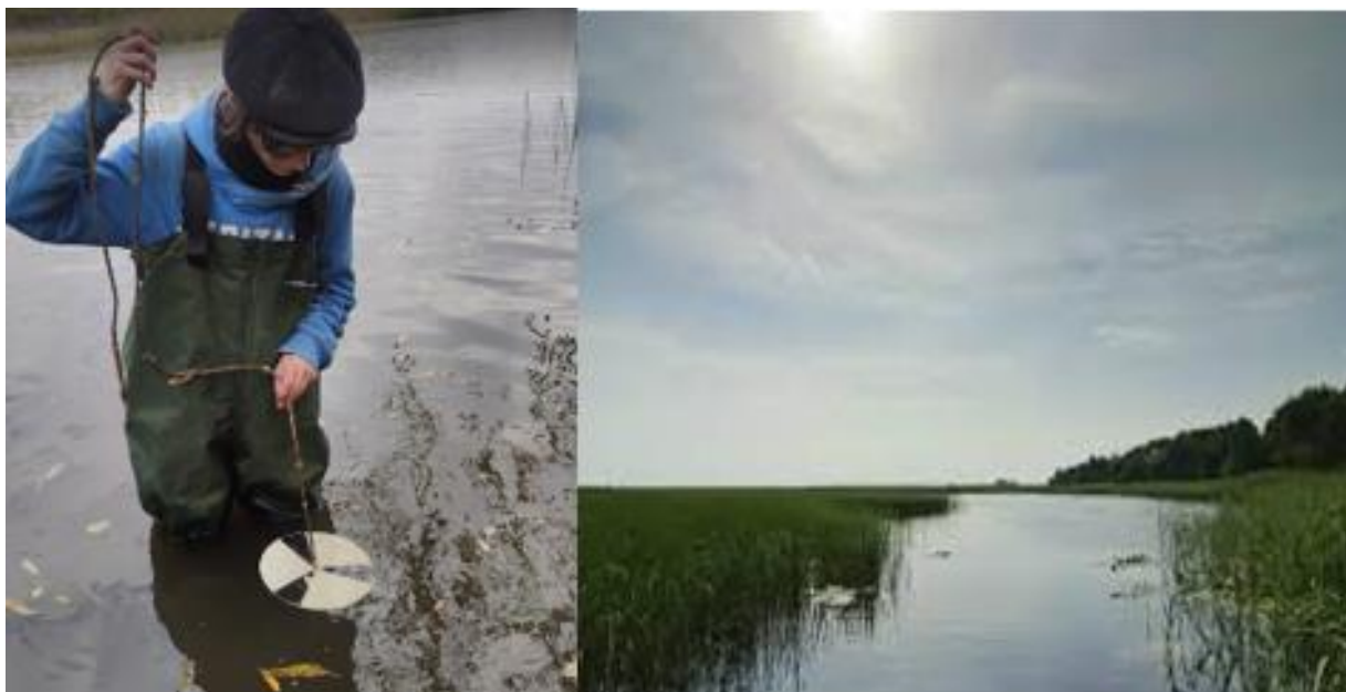
Рис. 2.3. Визначення каламутності води з допомогою диска Секкі Визначення концентрації кисню, рН та ТДС здійснювали з допомогою оксиметра, рН метра, TDS метра) (рис. 2.4).
