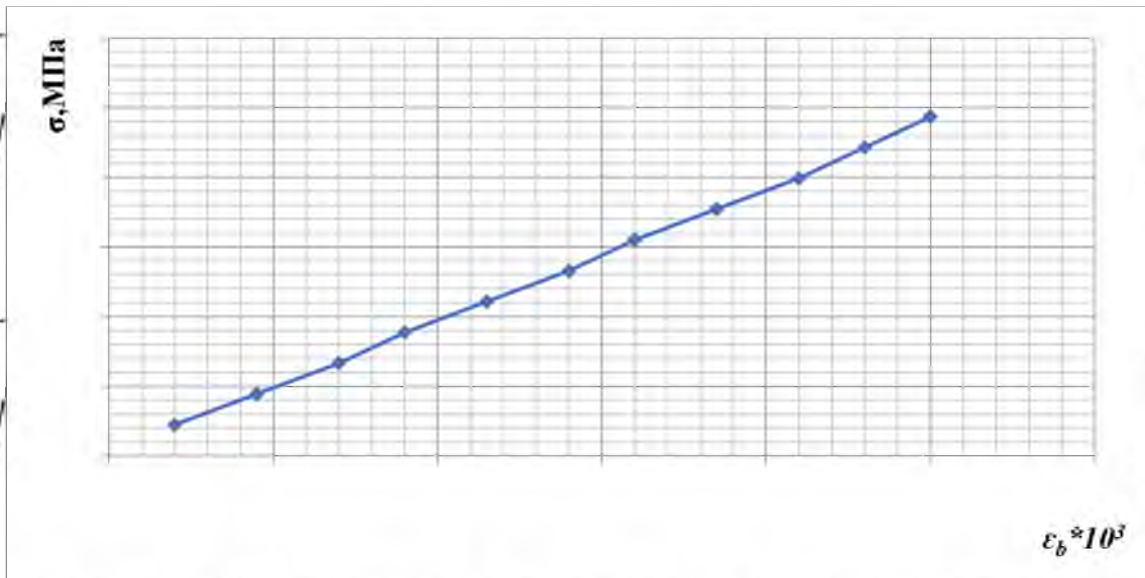
Рис. 7.4. Графік залежності між відносними деформаціями арматури та напруженнями для зразка №2.
