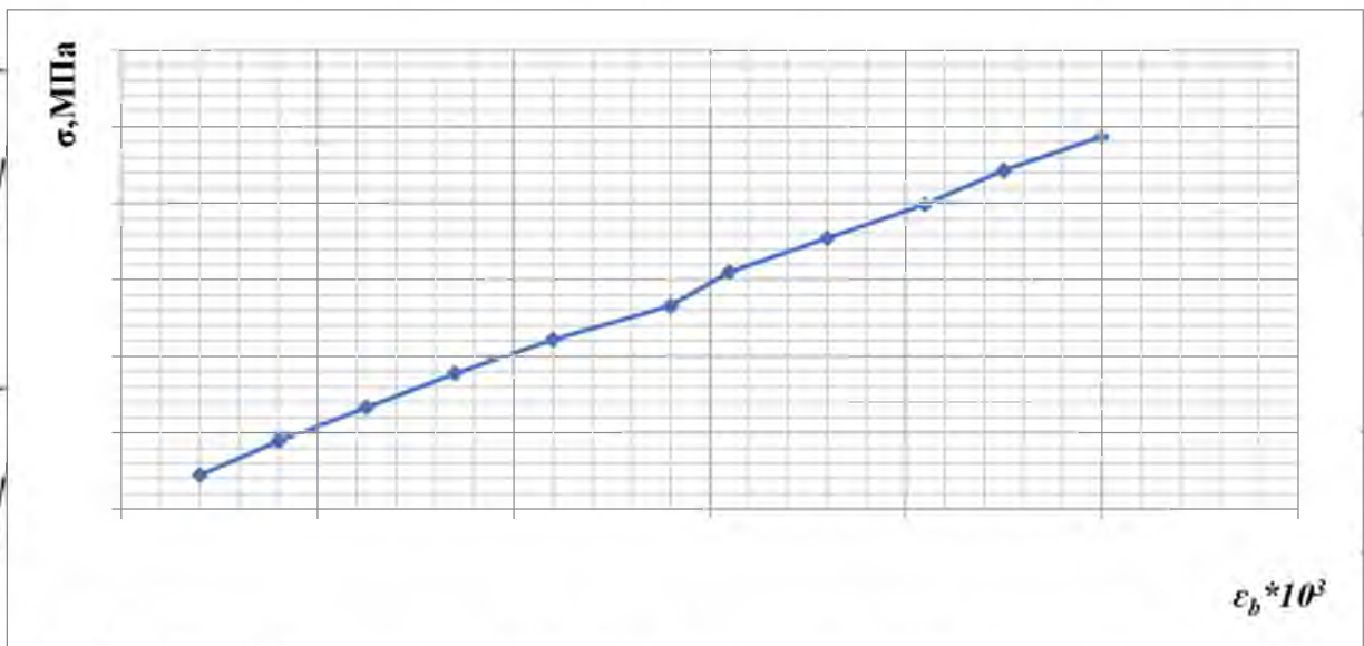
Рис.7.3. Графік залежності між відносними деформаціями арматури та напруженнями для зразка №1.
