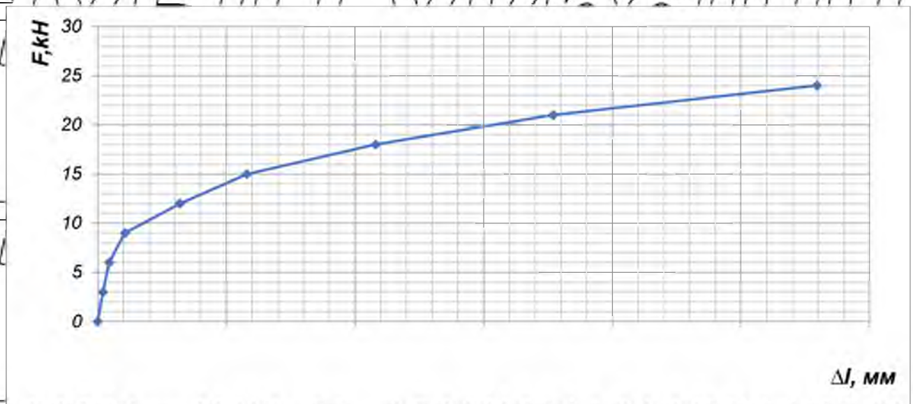
Рисунок 7.13 – Графік залежності \Delta(F) верхнього стержня балки Б-11
