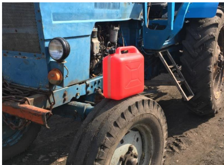
Рисунок 3.6 – Тарована каністра/бак для палива
