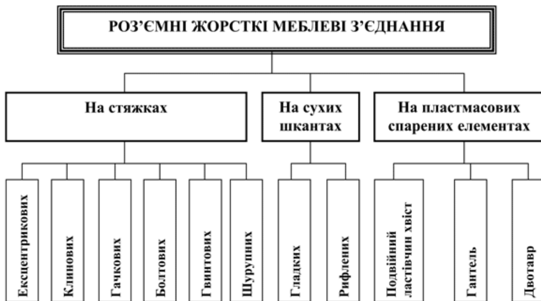
Рис. 1.1. Класифікація основних типів роз'ємних жорстких з'єднань [10]
