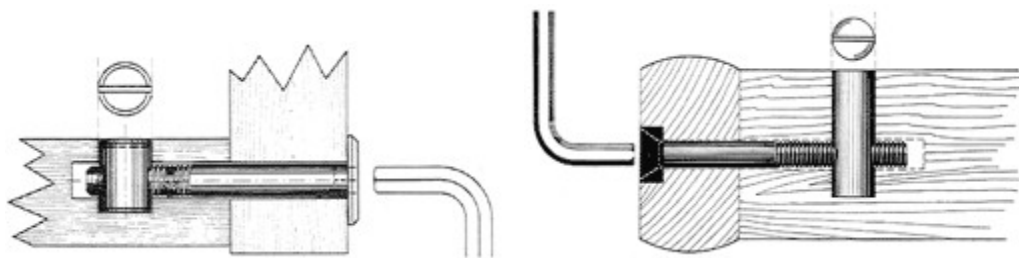
Рис. 1.3. Стяжка гвинтова та стяжка з конічним поглибленням на стержні [5]
