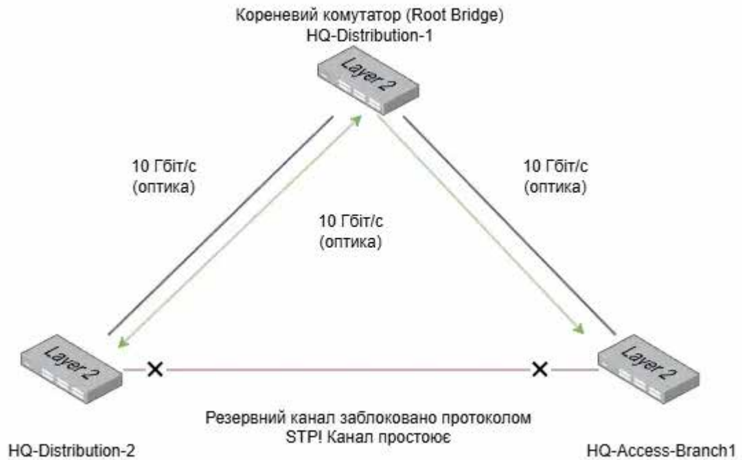
Рисунок 1.3 – Механізм блокування резервного порту протоколом STP
