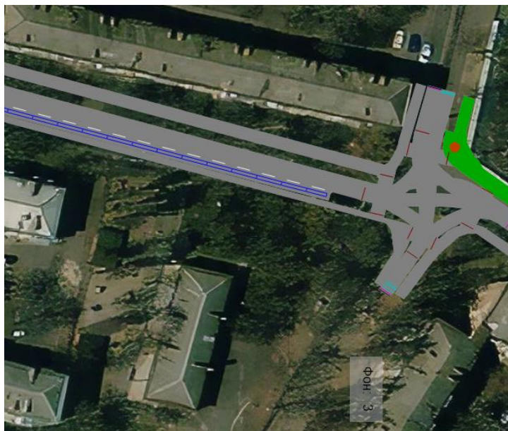
Рисунок 4.6. Проєктна модель у PTV Vissim: відокремлена велосмуга та звужена автомобільна смуга
