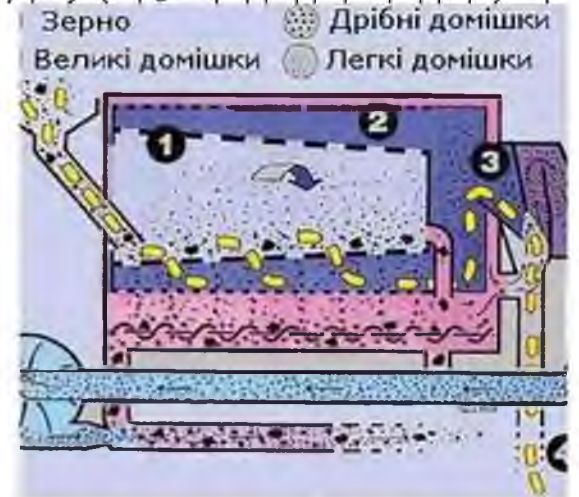
Рис. 1.7. Загальний вигляд (а) та схема технологічного процесу (б) барабанного сепаратора зернових культур.
