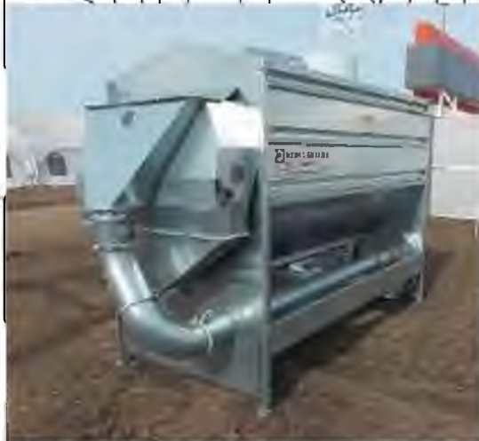
Рис. 1.7. Загальний вигляд (а) та схема технологічного процесу (б) барабанного сепаратора зернових культур.
