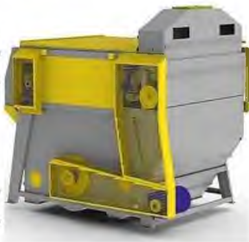
Рис. 1.6. Загальний вигляд (а) та схема технологічного процесу (б) сепаратора попереднього очищення зерна СВН-70
