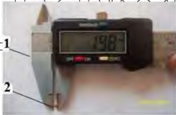
Рисунок 3.2. Вимрювання розмірів насінини 1 – штангенциркуль ШЦ-1, 2 – насінини
