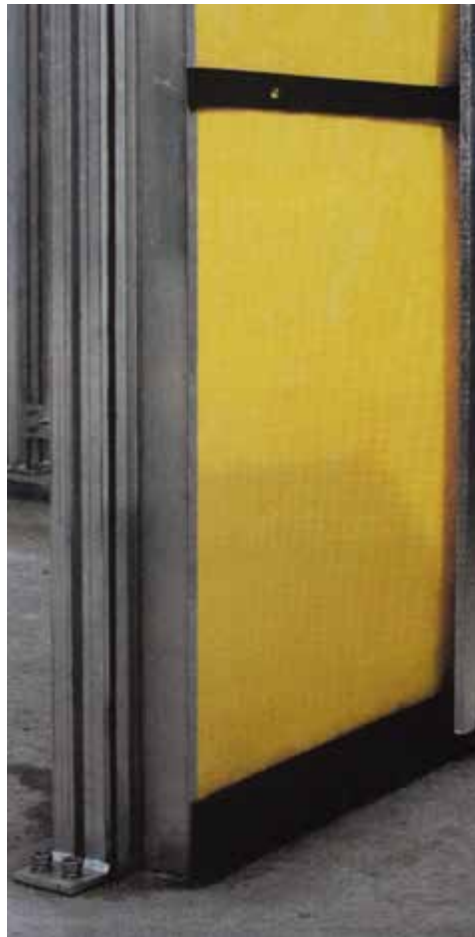
Рисунок 5.12. Елемент стінки сушарки із теплоізоляцією
