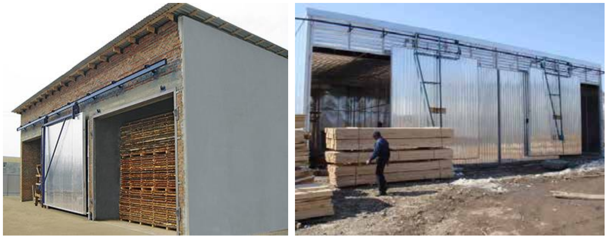
Рисунок 5.8. Конвекційні сушильні камери: а – стаціонарні; б – збірні
