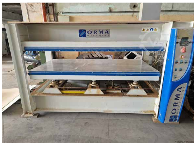
Рис. 3.2. Візуальний вигляд пресу ORMA NPC 6/90 AS-BO 2500 x 1300
