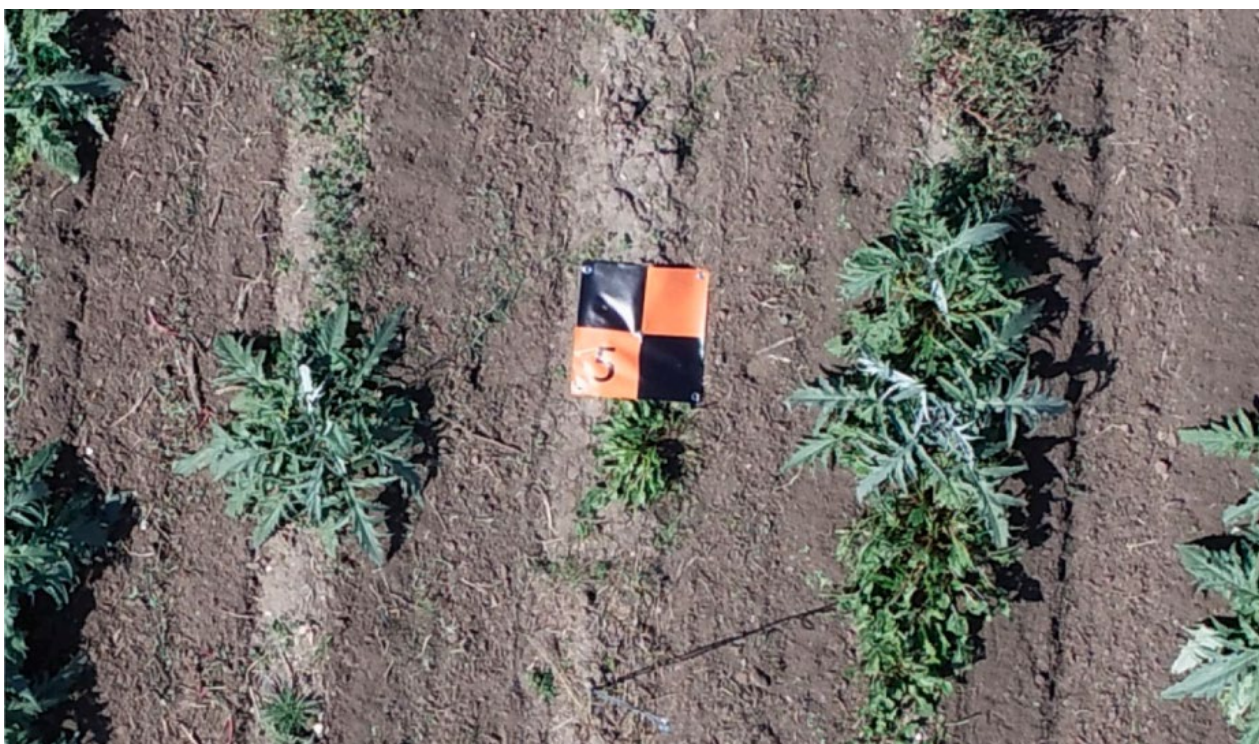
Рис. 3.8. Одна із 12 опорних точок (0,5х0,5 м), що використовуються для прив'язки зображень
