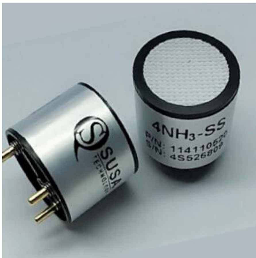
Рисунок 1.2 – Зображення електрохімічного датчику.
