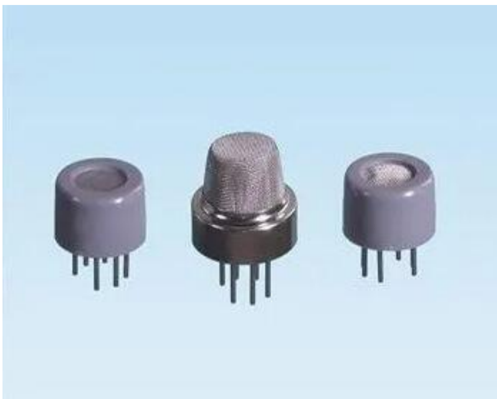
Рисунок 1.1 – Зображення напівпровідникового датчику.
