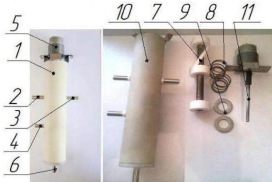
Рисунок 3.1 - Механічний пульсатор доїльного апарату: 1 - пульсатор у зборі, 2, 3, 4, 6 - патрубки, 5 - електродвигун, 7 - золотник, 8 - пружина, 9 - шайба проставальна, 10 - корпус пульсатора, 11 - вал шліцевий
