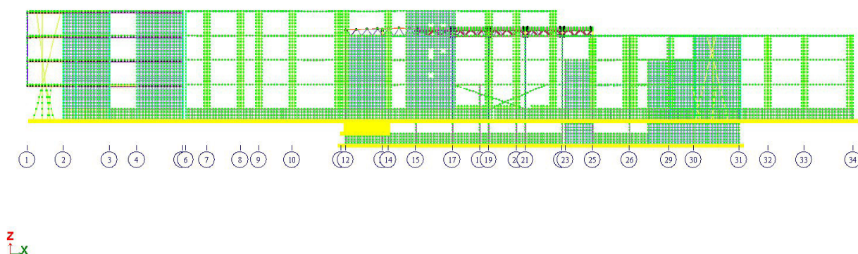
Рис. 3.7. Розрахункова схема будівлі школи в ПК «ЛІРА САПР»:
