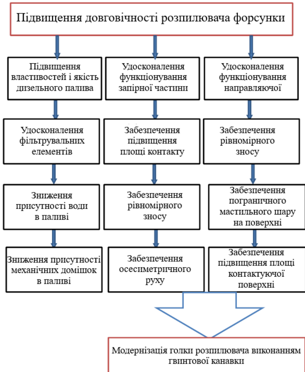
Рис. 2.2. Схема підвищення довговічності форсунки розпилювача
