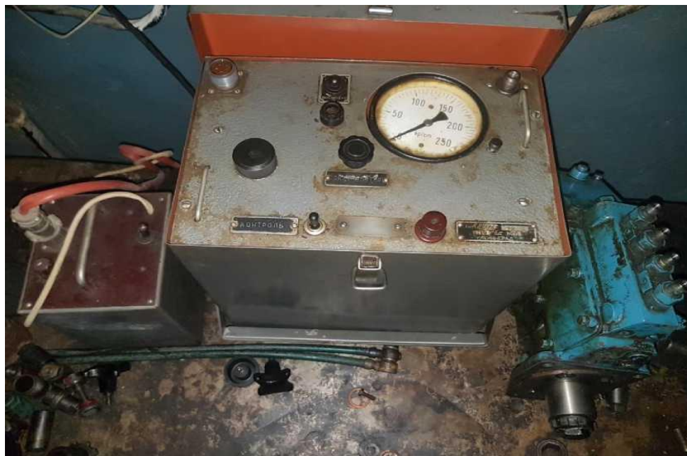
Рейс. 3.4. Прилад ПУФ 3 для визначення рухливості голки розпилювача
