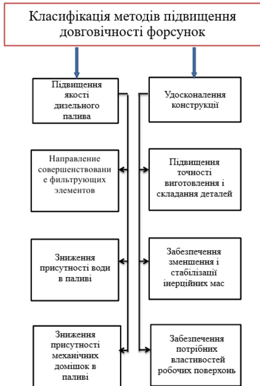
Рис. 1.9. Схема класифікації існуючих методів підвищення довговічності та продуктивності розпилювальних форсунок.
