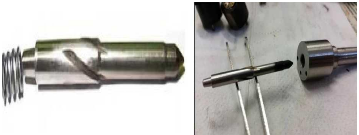
Рис. 1.12. Розпилювач форсунки Євро 5 L341PBD (DELPHI) з гвинтовими канавками в направляючій частині.
