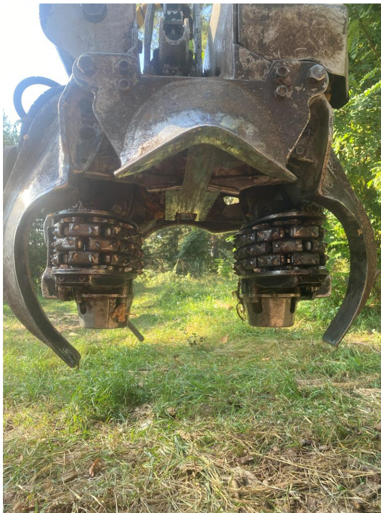
Рис. 4.3. Зображено основний механізм харвестера – валкову голову, яка зрізає та розкрязовує дерево (фото автора)
