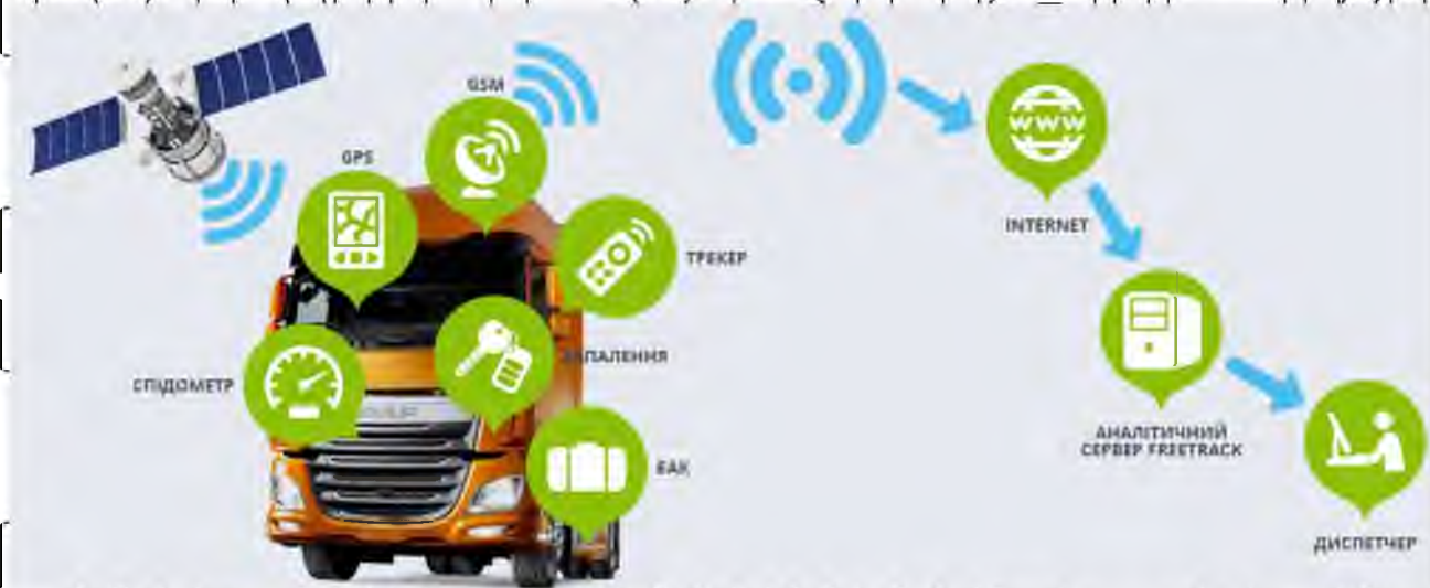
Рис. 1.1. Схема технологій відстеження вантажів
