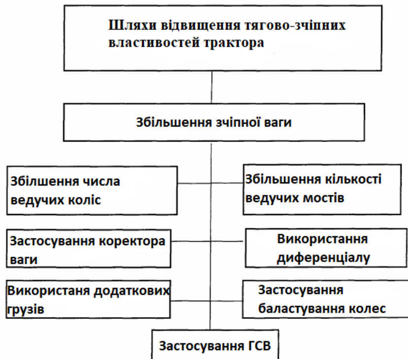
Рисунок 1.7 - Шляхи підвищення тягово-зчіпних властивостей трактора
