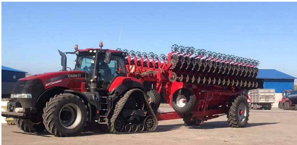
Рис.1.1. Агрегат Case MX 380 + Horsh Maestro 36.5, що використовується в технологіях No-till та Strip-till.
