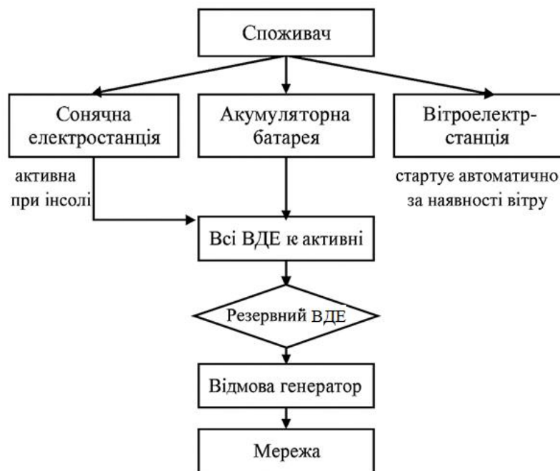
Рис. 2.12 Блок-схема логіки перемикавання джерел живлення гібридної енергетичної установки
