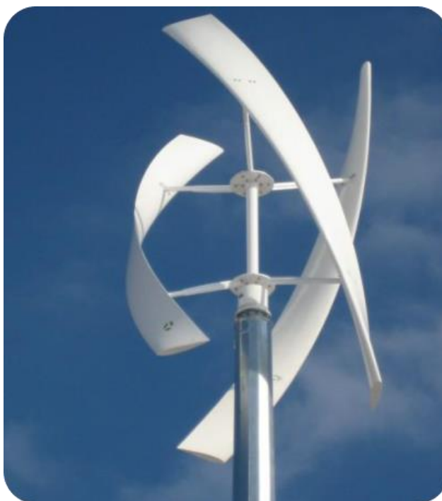
Рис. 1.3. Конструктивна схема ВЕУ з вертикальною віссю обертання
