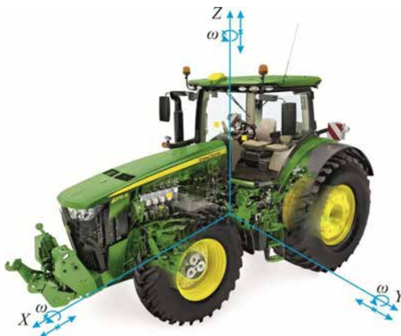
Рисунок 1. Коливання трактора відносно осей OX , OY та OZ
