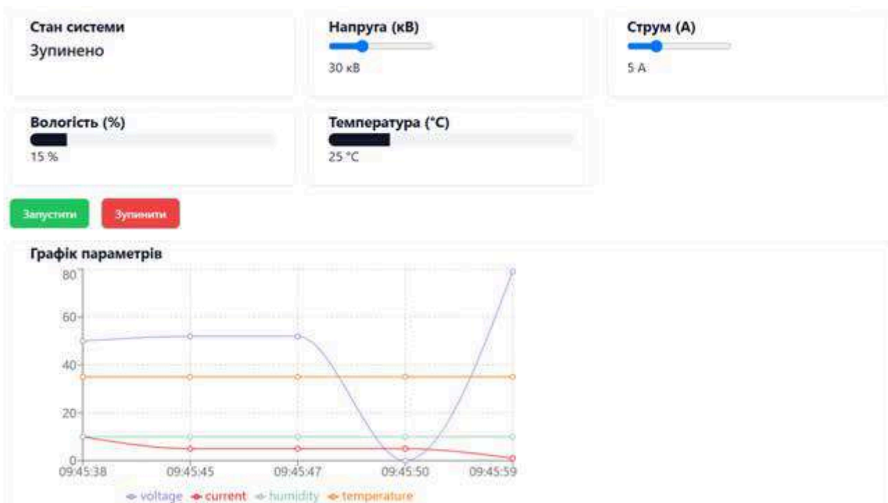
Рис. 4.13. Візуальний інтерфейс SCADA-системи для моніторингу та керування процесом знезараження зерна з графіком технологічних параметрів
