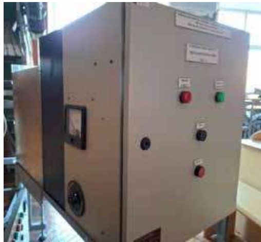
Рис. 1.6. Зовнішній вигляд установки для передпосівної обробки насіння сільськогосподарських культур в електричному полі високої напруженості
