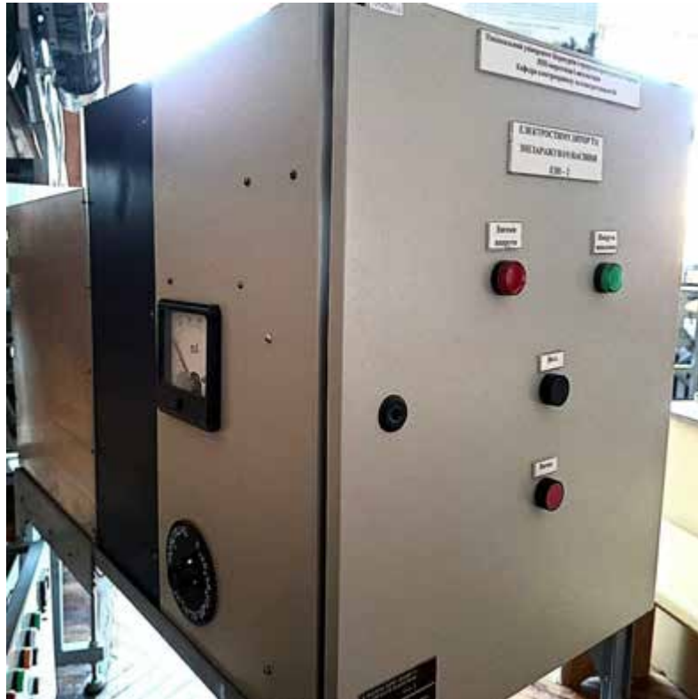
Рис. 4.6 Зовнішній вигляд установки для обробки зернових в електричному полі високої напругеності
