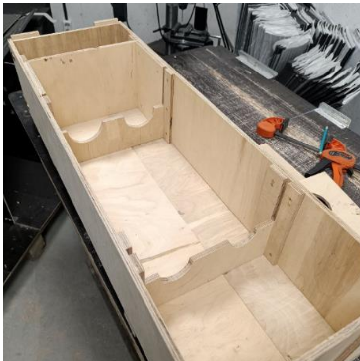
Рис. 3.9. Процес монтування перегородки та ложемент
