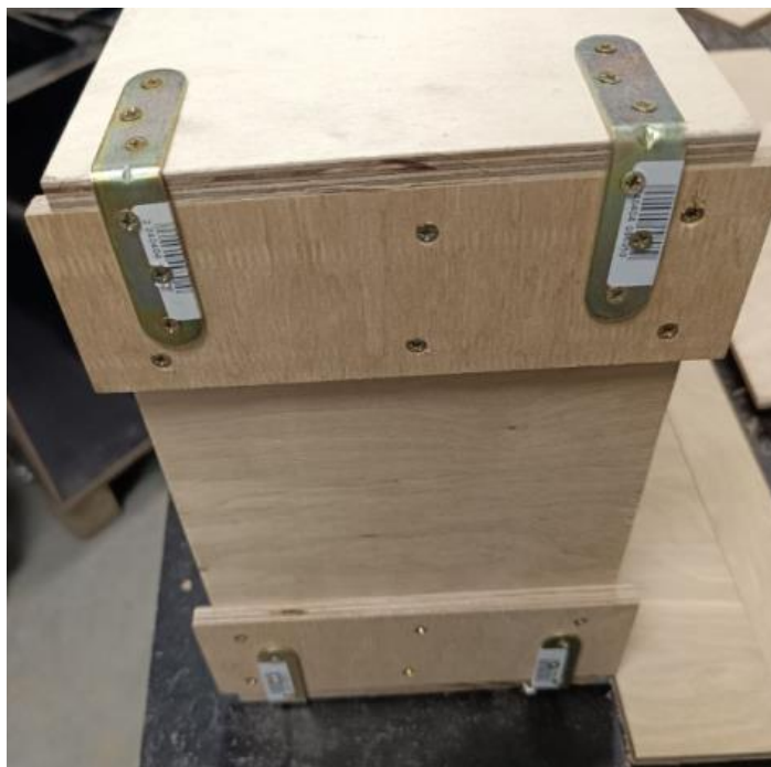
Рис. 3.8. Процес встановлення металевих кутників
