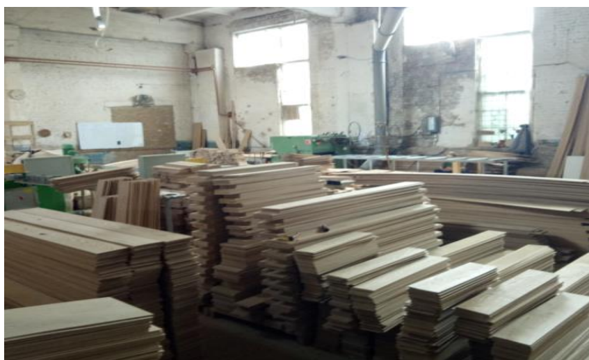
Рис. 3.2. Випиляні заготовки для тари
