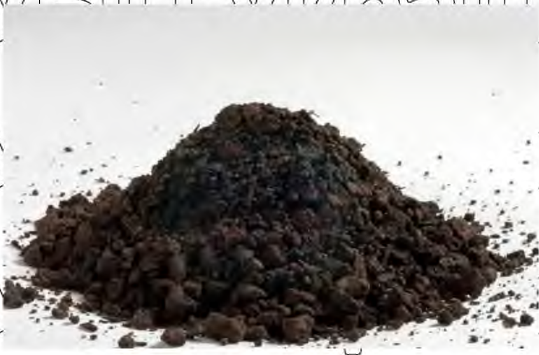
Рис. 4.14. Грунтосуміш Optigrün Extensive Multi Layer Substrate E-light, [54].
