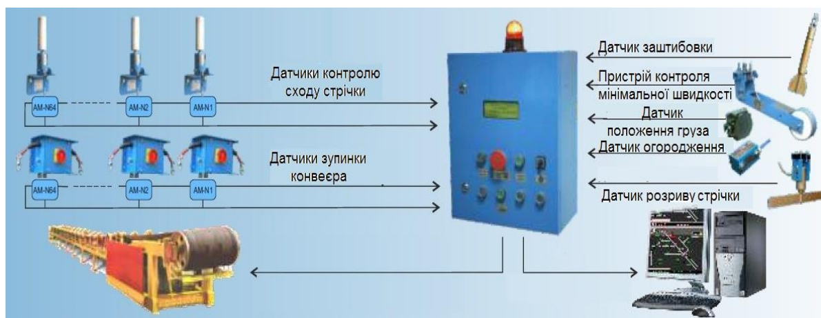
Рисунок 1.11 – Датчики та запобіжні пристрої [5]
