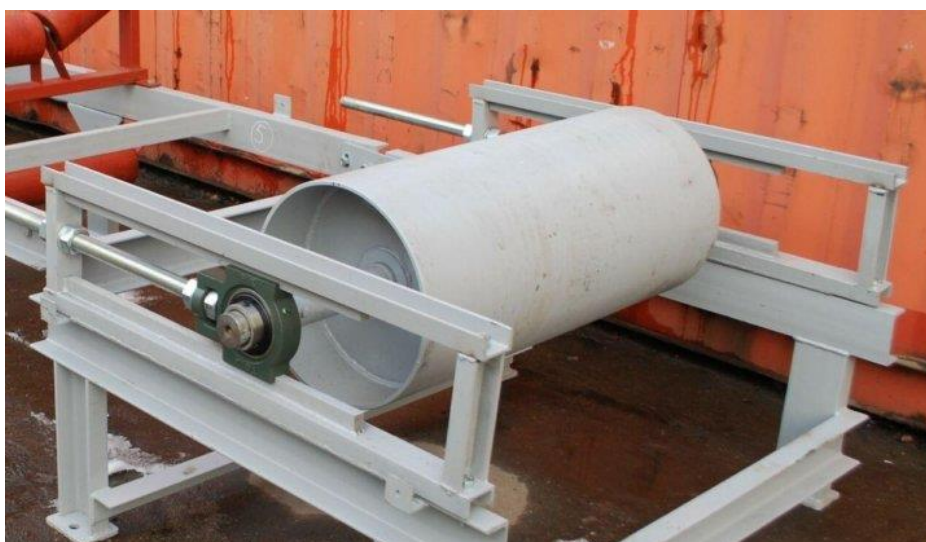
Рисунок 1.7 – Натяжний барабан з механізмом натягу [6]
