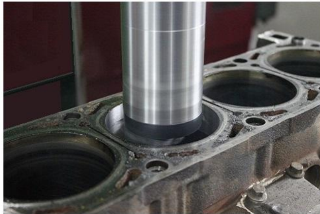
Рис. 2.3 Розточування блока циліндрів
