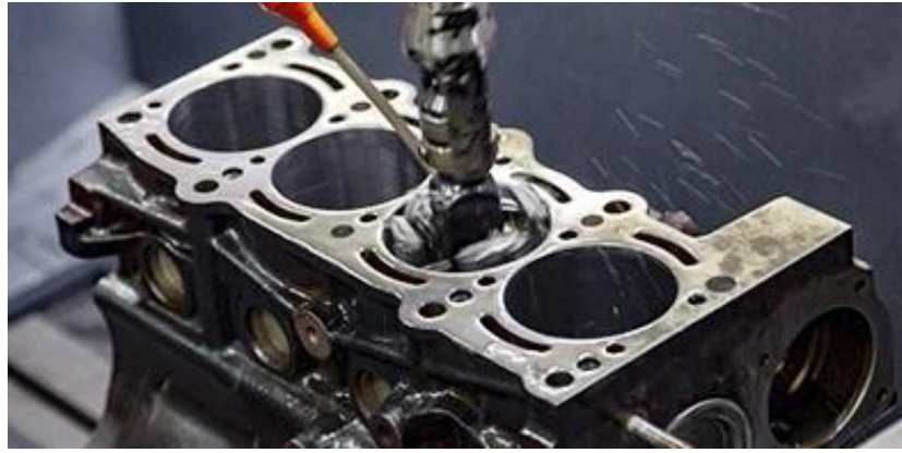
Рис. 2.4 Хонінгування блока циліндрів
