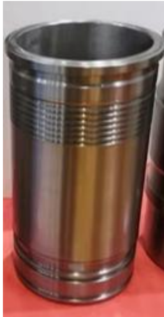
Рис. 2.4. Гільза двигуна , що відновлюється
