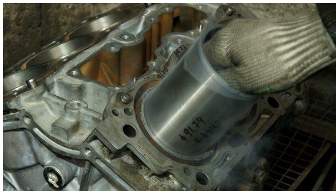
Рис. 2.3 Заміна гільз в блоці
